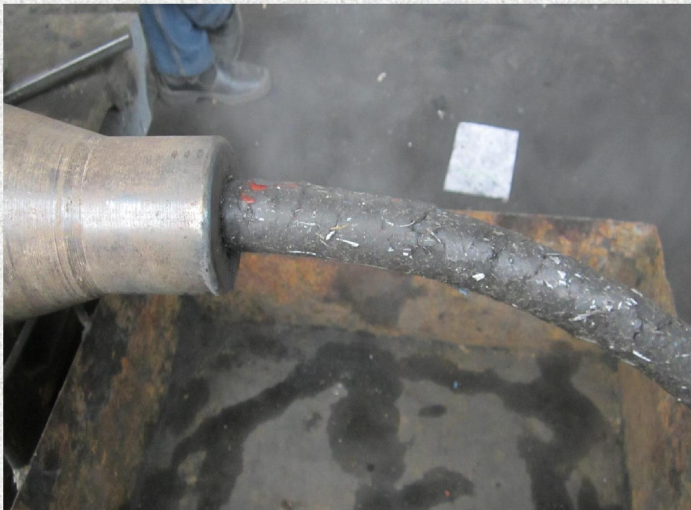
Процесс брикетирования измельчённого ТБО в шнекопоршневом прессе
