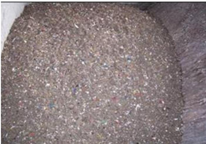
Обезвреженные «хвосты» ТБО – наполнитель для бетонов.
