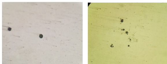
Рисунок 2 – Глобулярные включения, х500
