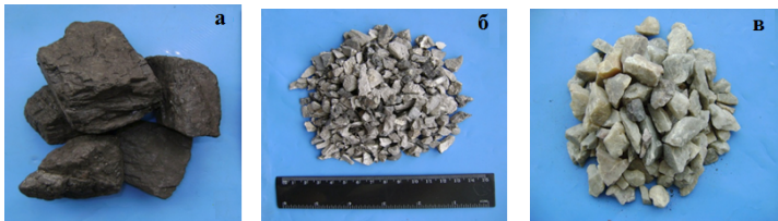
а – высокозольный Борлинский уголь; б – металлические отсеvy высокоуглеродистого феррохрома; в – кварцит
