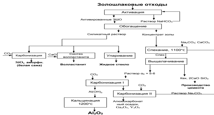
Рисунок 1- Технологическая схема безотходной технологии зол ТЭС
