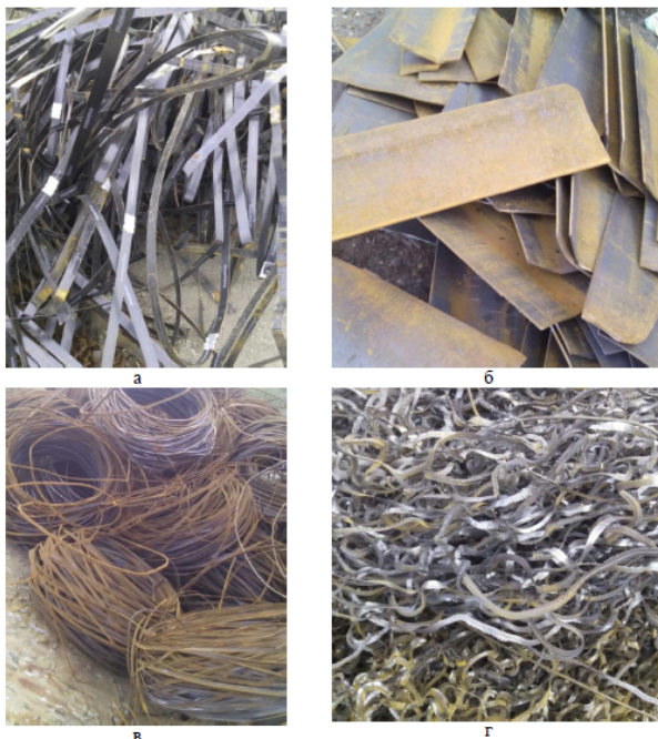
Рисунок 2 – Классификация видов отходов при производстве сварных труб:
