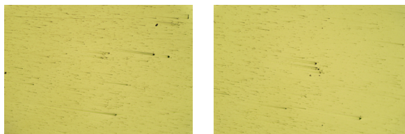
Рисунок 1 – Общий вид неметаллических включений, х200
