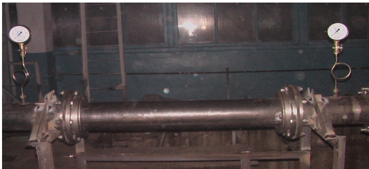
Рисунок 2 – Экспериментальная модель гидротурбины
