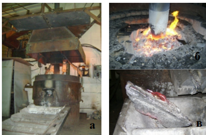
а – общий вид однофазной руднотермической печи; б – состояние колошника; в – слиток сплава, полученной карботермическим способом
