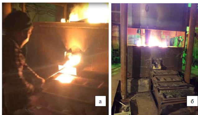
а – выпуск марганцевой лигатуры; б – рудно-термическая печь 300кВА.
